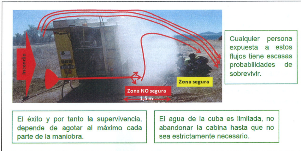
Figura 4: Esquema de la dirección de los flujos de aire caliente, de la zona segura del personal y de la disposición de la pantalla de agua.
